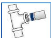
Клей наносится сплошным слоем на 1-2 шага резьбы от ведущего края. Нанесение достаточного количества вещества обеспечит полную герметизацию. Для конической/параллельной резьбы убедитесь, что
