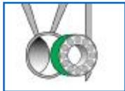
Наносится по кругу, предпочтительно на охватываемую деталь. Монтируется вращательно-поступательными движениями. Для более крупных деталей используйте тиксотропные материалы для предотвращения стекания клея. Убедитесь в том, что клей не попал в кольца шарикоподшипника или другие подвижные механизмы.
