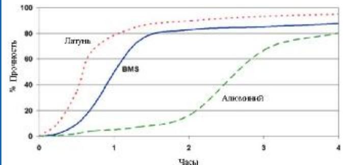
Время затвердевания рассматривается обычно при 23°C. Меди и ее сплавам соответствует более быстрое затвердевание, чем окисленным или пассивным поверхностям, таким как нержавеющая сталь, которой соответствует более медленное затвердевание. Чем ниже температура или чем шире зазор, тем больше время затвердевания. Для сокращения времени затвердевания можно либо использовать [Permabond A905](#), либо высокую температуру, по выбору.
