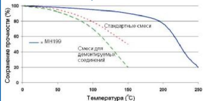
На данном графике показана зависимость прочности от температуры при условии, что место соединения не перегружено. Подвергать соединения высоким температурам можно только в течение коротких промежутков времени.
