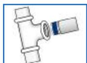
Клей наносится сплошным слоем на 1-2 шага резьбы от ведущего края. Нанесение достаточного количества вещества обеспечит полную герметизацию. Для конической/параллельной резьбы убедитесь, что клей нанесен на места полного стыка частей резьбы. Зазоры, а значит и время затвердевания, могут оказаться больше, чем ожидалось для резьбы данной конфигурации. Затяните при помощи обычных инструментов.
