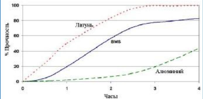
Время затвердевания рассматривается обычно при 23°C. Медь и ее сплавам соответствует более быстрое затвердевание, чем окисленным или пассивным поверхностям, таким как нержавеющая сталь, которая имеет тенденцию к более медленному затвердеванию. Чем ниже температура или чем шире зазор, тем больше время затвердевания. Для сокращения времени затвердевания можно либо использовать [Permabond A905](#), либо высокую температуру, по выбору.
