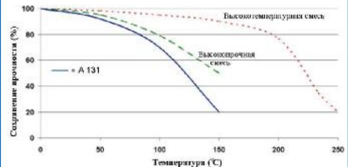
Уменьшение прочности обратно пропорционально охлаждению при условии, что место соединения не перегружено. Кратковременное воздействие более высоких температур может быть приемлемо.
