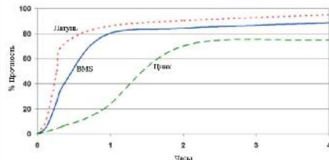
Время затвердевания рассматривается обычно при 23°C. Медь и ее сплавам соответствует более быстрое затвердевание, чем окисленным или пассивным поверхностям, таким как нержавеющая сталь, которой соответствует более медленное затвердевание. Чем ниже температура или чем шире зазор, тем больше время затвердевания. Для сокращения времени затвердевания можно либо использовать [Permabond A905](#), либо высокую температуру, по выбору.
